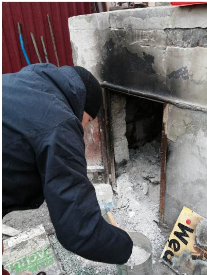
Podczas pobierania próbek popiołu z pieca podczas kontroli prawidłowości spalania. Fot. UG
