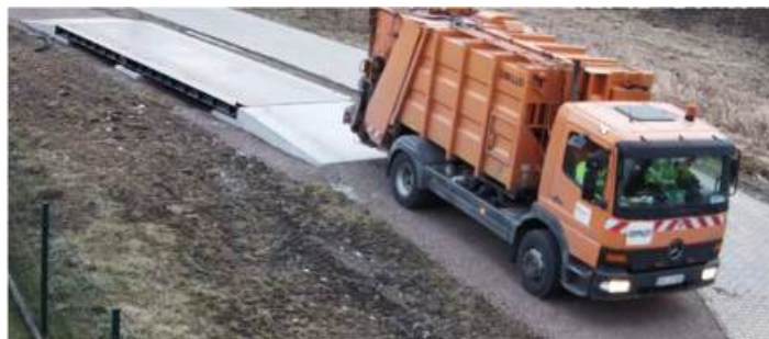
Na punkcie selektywnej zbiórki odpadów komunalnych w Sieprawiu w 2019 zamontowano profesjonalną wagę samochodową do ważenia odpadów z terenu Gminy.
